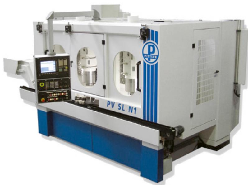
Pittler Pick-up-Drehmaschine PVSL/N1
