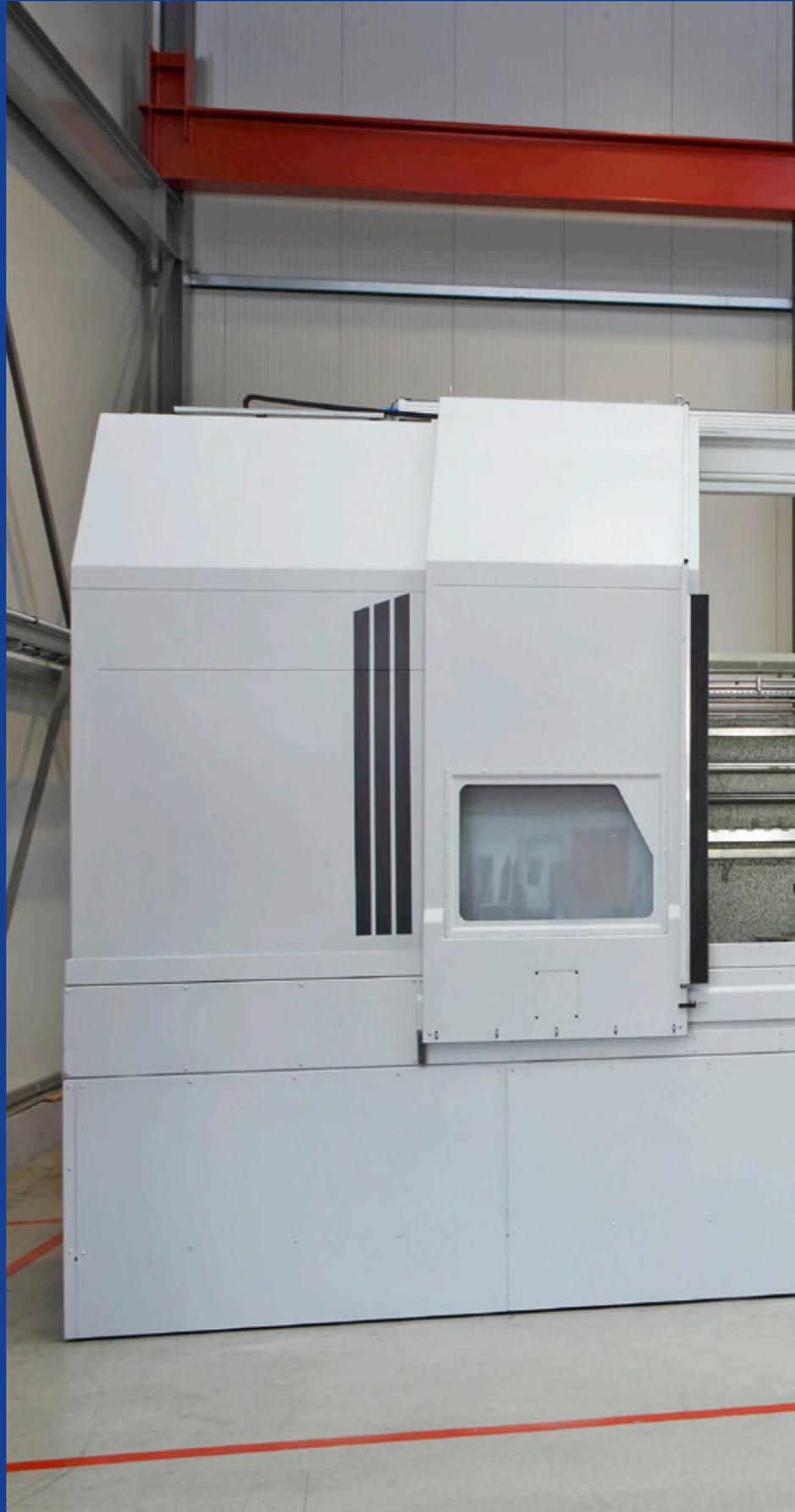
*Buderus Pendelschlitten-Simultanschleifmaschine (BV 800)
