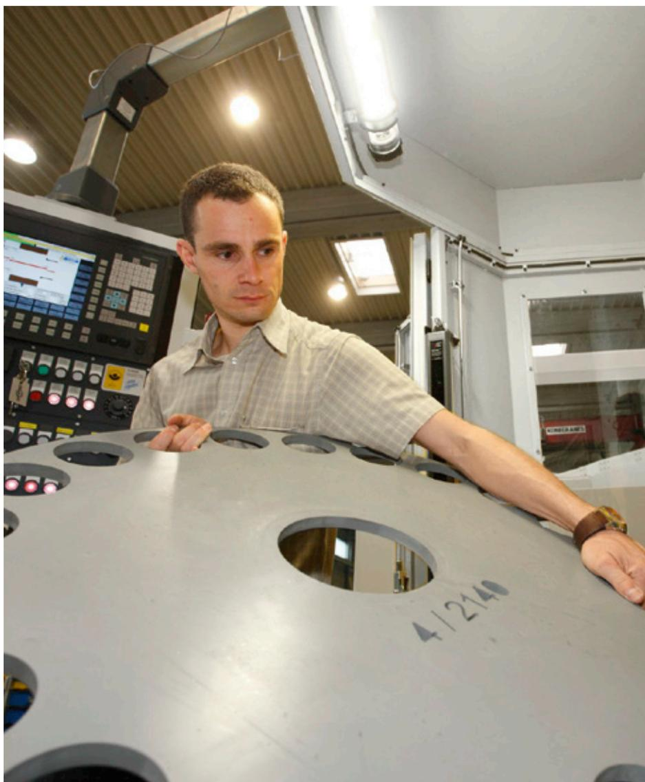
*Austausch einer Transportscheibe in einer Doppelpanschleifmaschine DDS*
