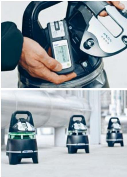
**01** Zum Aufspüren von Gasen nutzt das ›Dräger X-zone 5000‹ bestehende tragbare Messgeräte.
