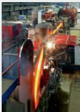
Die logistisch sehr gut gelegene Deutsche Gießdraht GmbH in Emmerich am Rhein ist spezialisiert auf die Produktion von Gießwalzdraht. Dieser ist vor allem das Vorprodukt für die Herstellung von Kupferdrähten, die als Kupferwicklungen in Transformatoren und Motoren sowie in der Kabelherstellung zum Einsatz kommen. Gefertigt werden unter Anwendung des Southwire-Verfahrens vielfältige Produktvarianten. Die Vermarktung erfolgt anteilig durch die Gesellschafter des Unternehmens.
