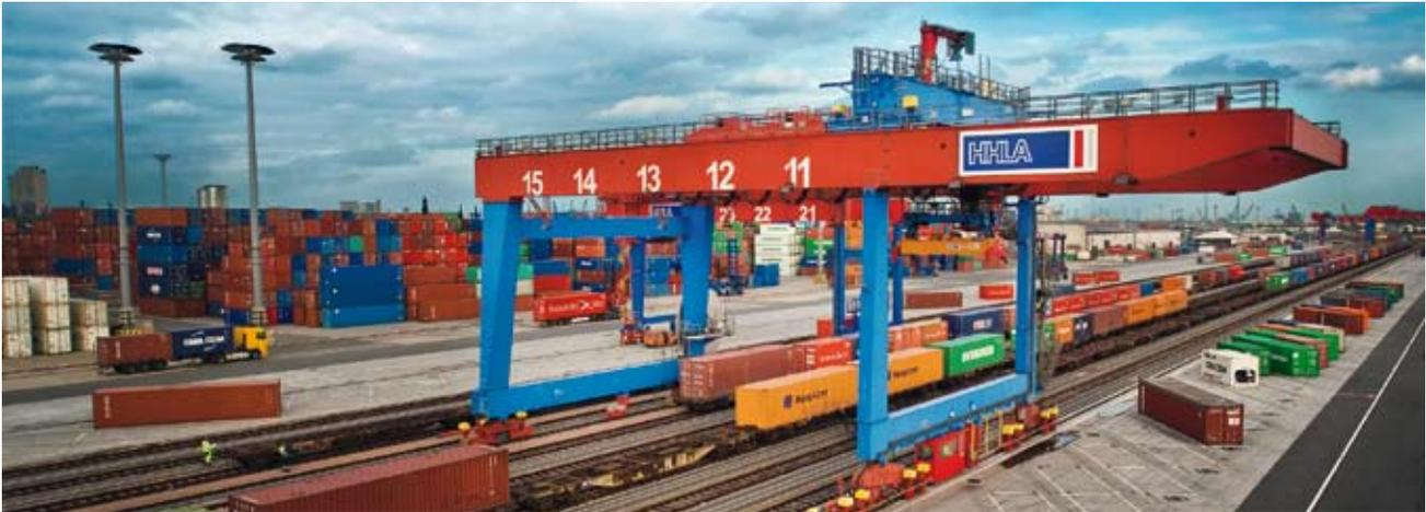
Der 2006 eingeweihte Containerbahnhof auf dem Burchardkai: Bahnkräne bearbeiten Ganzzüge auf acht über 700 Meter langen Gleisen.
