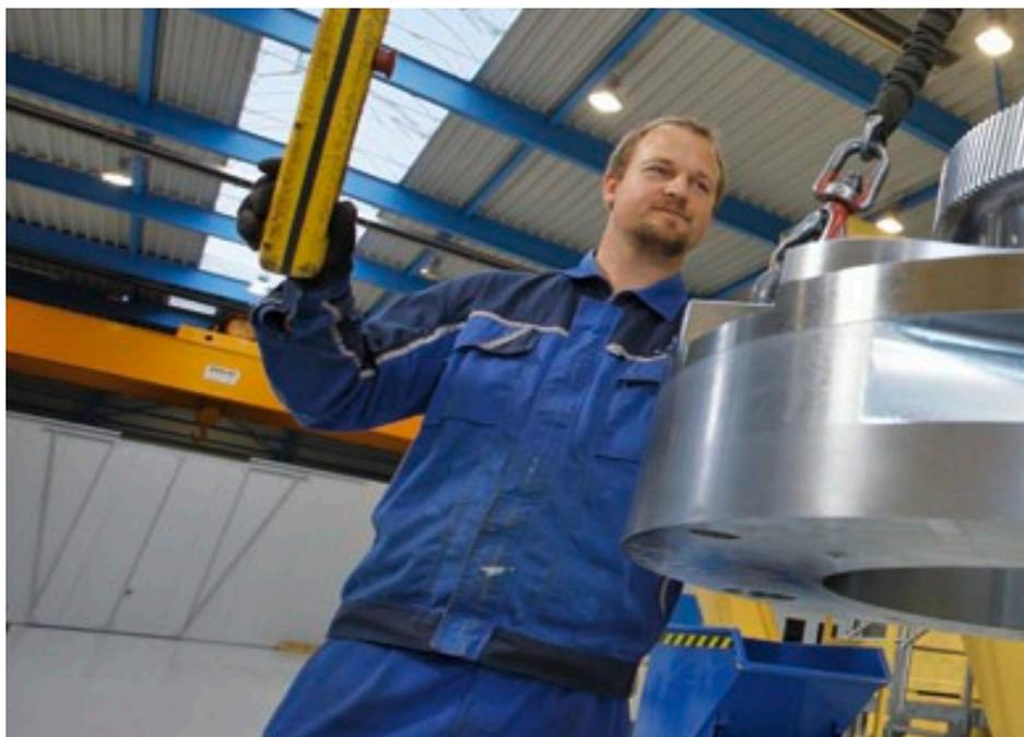
*Werkstück für die Komplettbearbeitung (5-Achsen)
