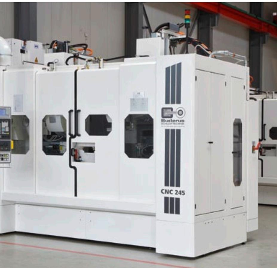
Mittelantriebsmaschine Buderus CNC 245 zum Innen- und Außenschleifen von Hohlwellen
