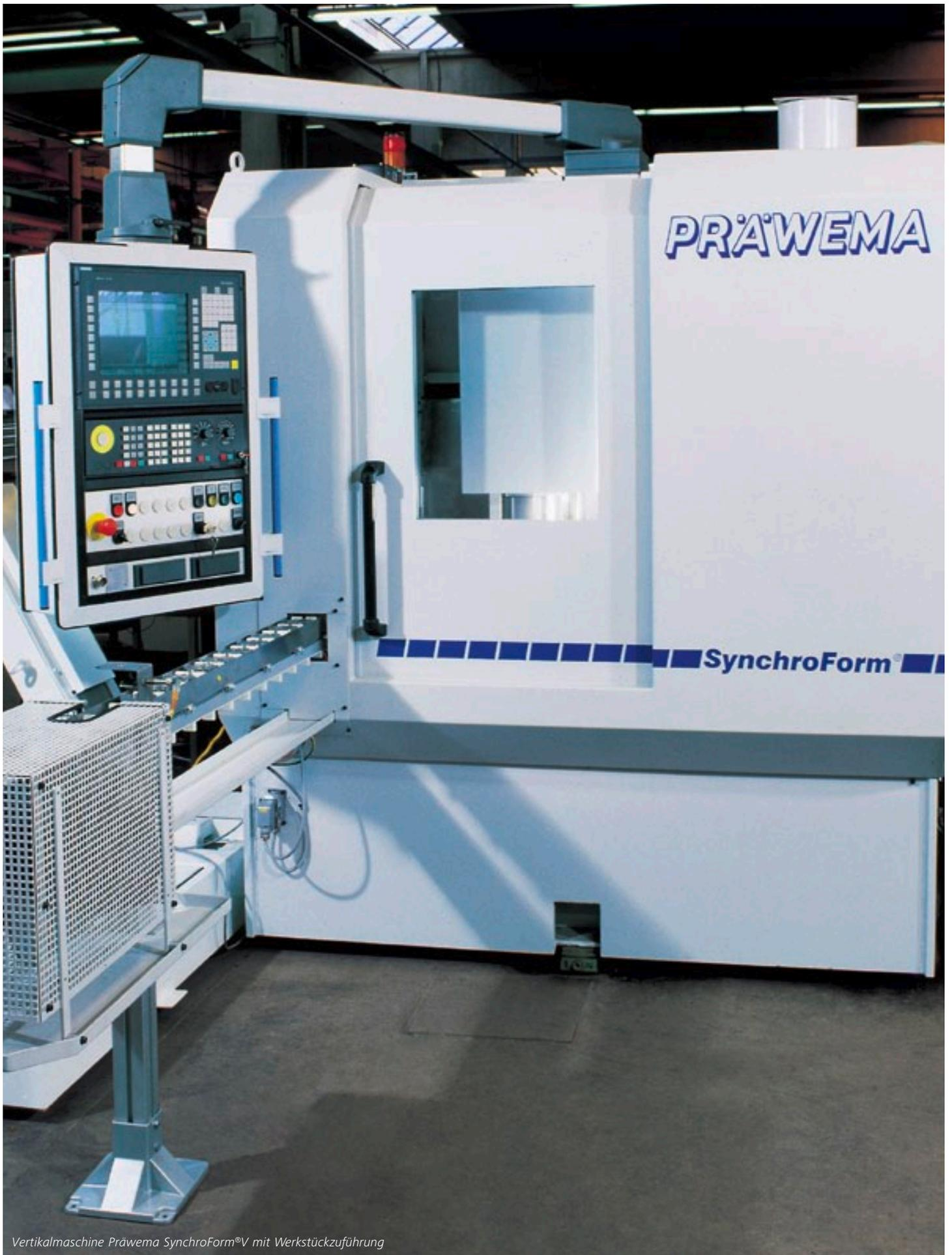
Vertikalmaschine Präwema SynchroForm®V mit Werkstückzuführung
