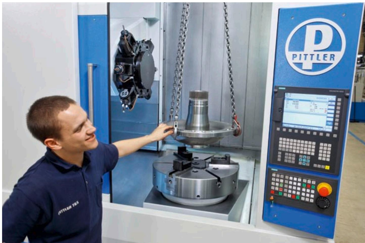
Werkstückspannung in einer PitTLer PV 630 ValueLine
