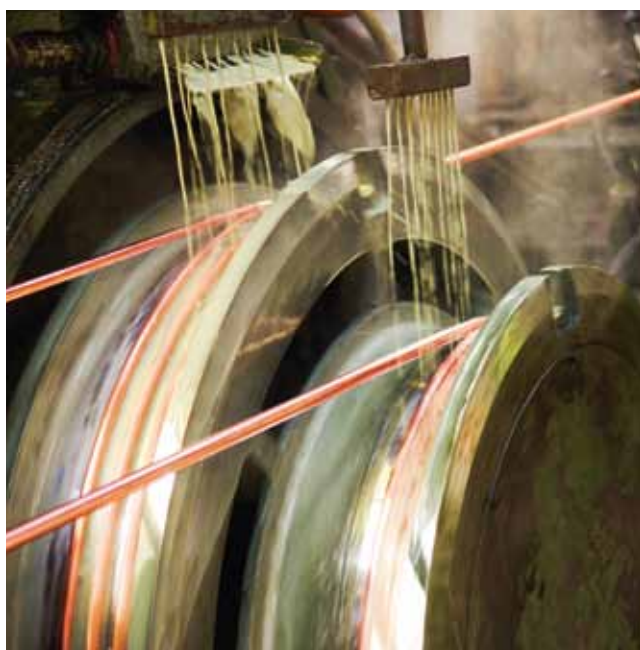
Ständige Kühlung und Schmierung sind bei der Kaltumformung zu Fahrleitungsdraht von großer Wichtigkeit.
