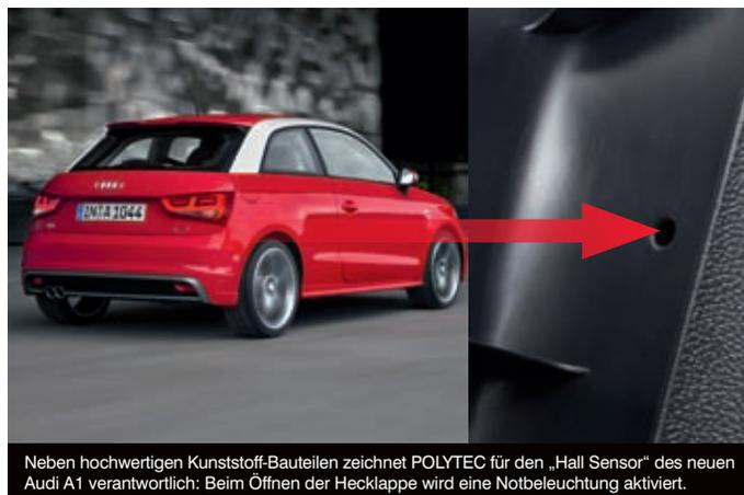
Neben hochwertigen Kunststoff-Bauteilen zeichnet POLYTEC für den „Hall Sensor“ des neuen Audi A1 verantwortlich: Beim Öffnen der Heckklappe wird eine Notbeleuchtung aktiviert.
