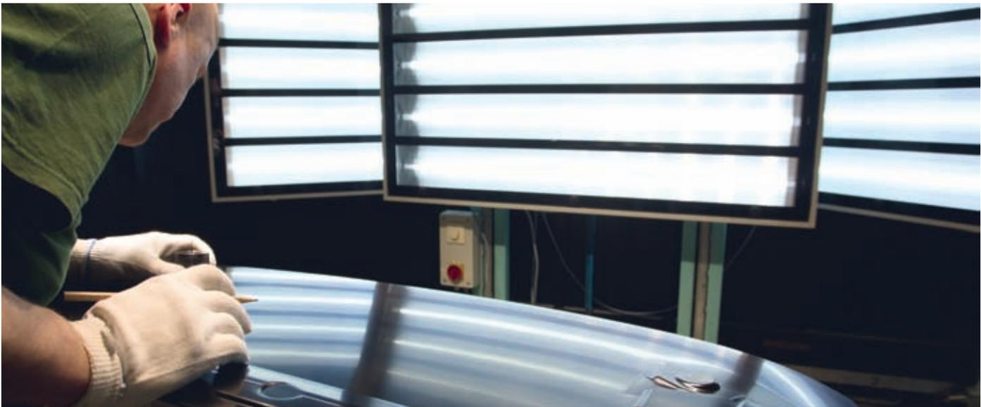
Höchste Qualitätsmaßstäbe in der Oberflächenbeschaffenheit sensibler Anbaukomponenten: Mit Streifenlichtmodulen werden kleinste Unregelmäßigkeiten sichtbar gemacht und eliminiert.
