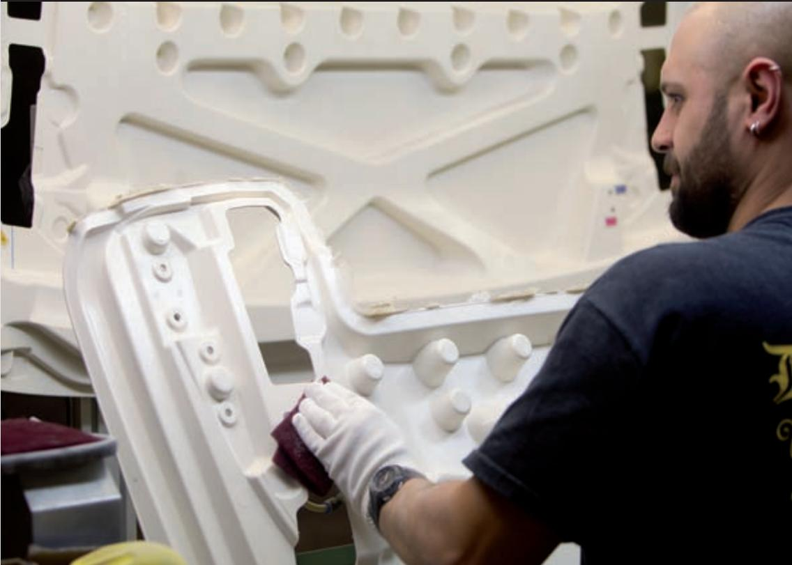
Bei allen Innenteilen werden nach dem Fräsen die Kanten händisch gebrochen.
