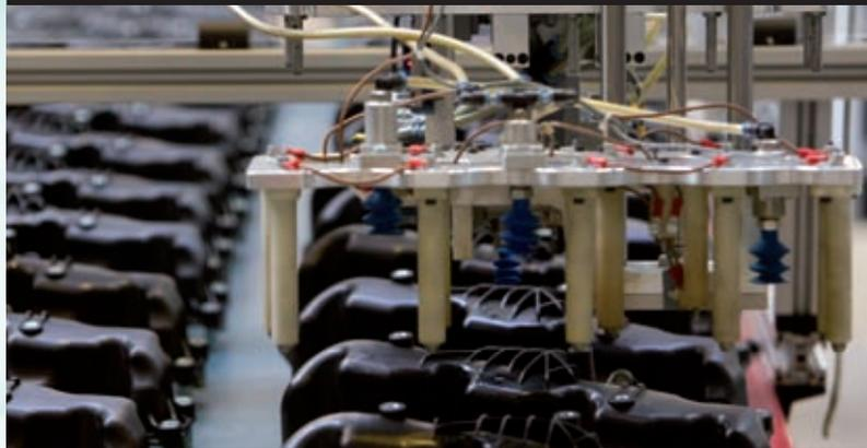
Produktprüfung wird groß geschrieben – hier werden die Buchsen der Saugrohre überprüft.
