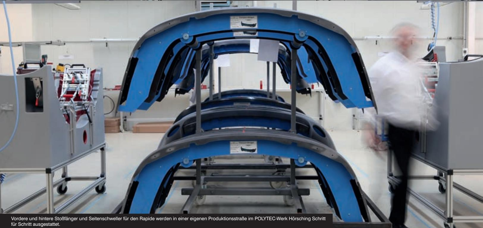
Vordere und hintere Stoßfänger und Seitenschweller für den Rapide werden in einer eigenen Produktionsstraße im POLYTEC-Werk Hörsching Schritt für Schritt ausgestattet.
