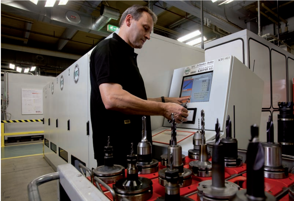
KTCs ermöglichen bedarfs- und zeitgerechte Bereitstellung von Zerspanungswerkzeugen
