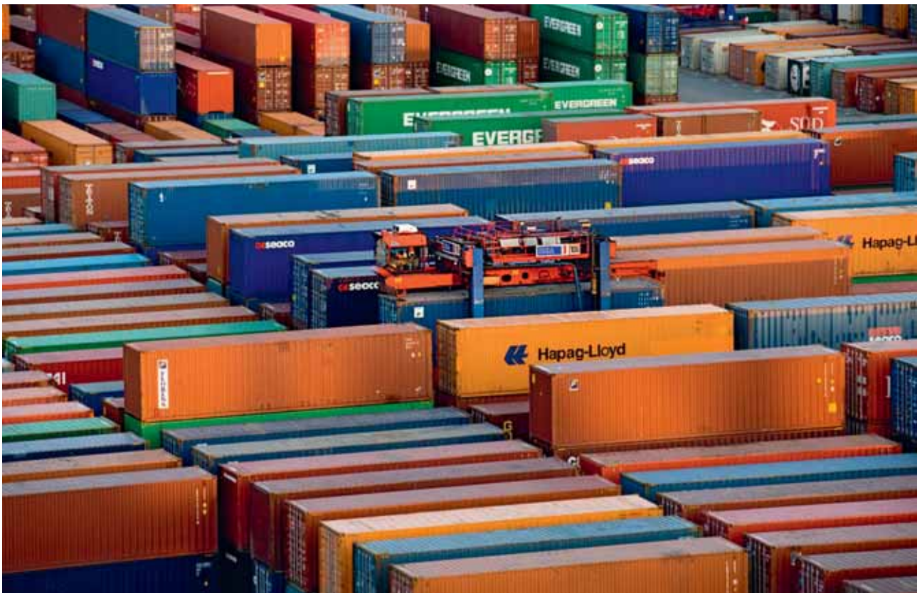
Ein hochbeiniger Van-Carrier setzt einen Container auf dem Burchardkai ab.
