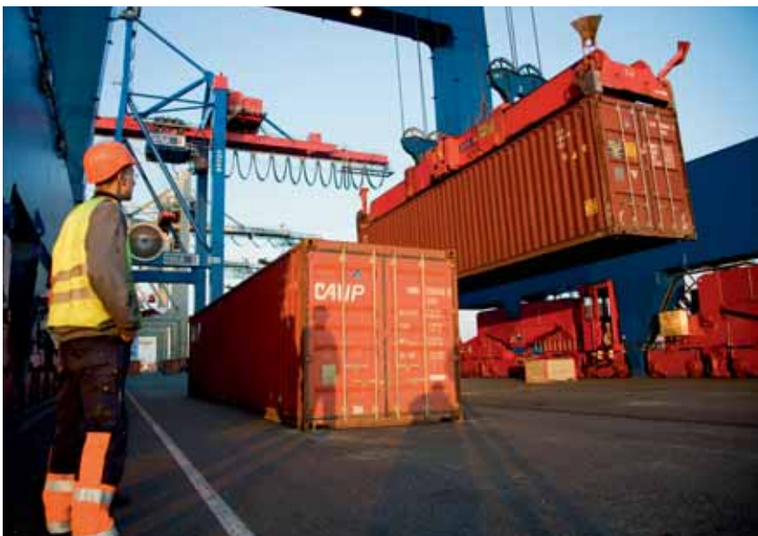
Container werden an der Kaikante abgestellt, bevor Van-Carrier sie ins Lager bringen.
