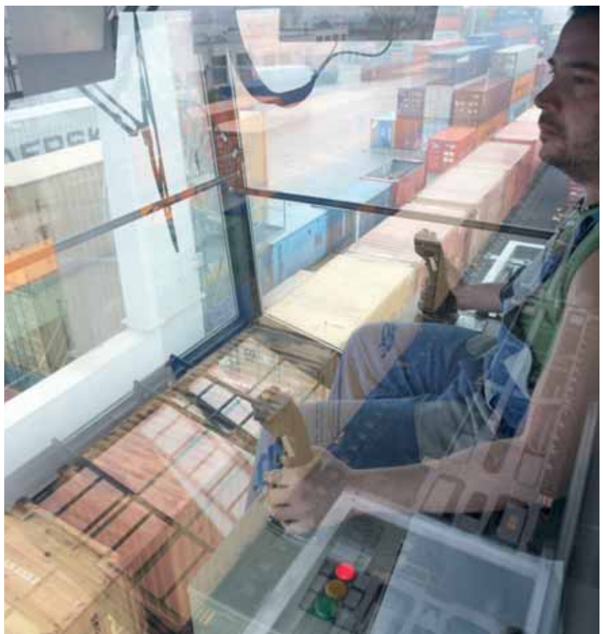
Brückenfahrer in der Kanzel eines Bahnkrans auf dem Inlandterminal von Metrans in Prag.
