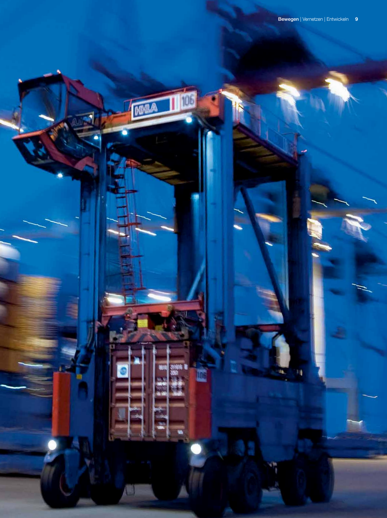
Van-Carrier beim Transport eines Containers auf dem HHLA Container Terminal Burchardkai.
