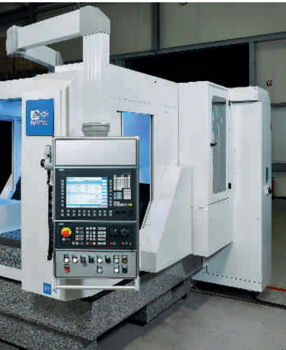
Horizontalschleifmaschine Buderus CNC 335 zur Gewindebearbeitung
