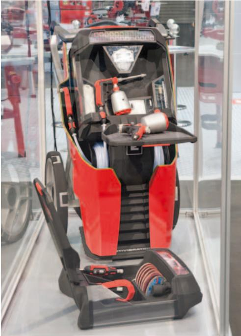
Besonderheiten wie Funktions-Einstellung über Touchscreen-Display, Werkzeuge mit digitaler Druckanzeige und Feineinstellung und automatische Luftdruck-Stabilisierung zeichnen diese Druckluft-Arbeitsstation aus. Mit dieser Vision stellt Einhell die große Innovationsfähigkeit des Unternehmens unter Beweis, die von der Fachpresse sehr positiv aufgenommen wurde.
