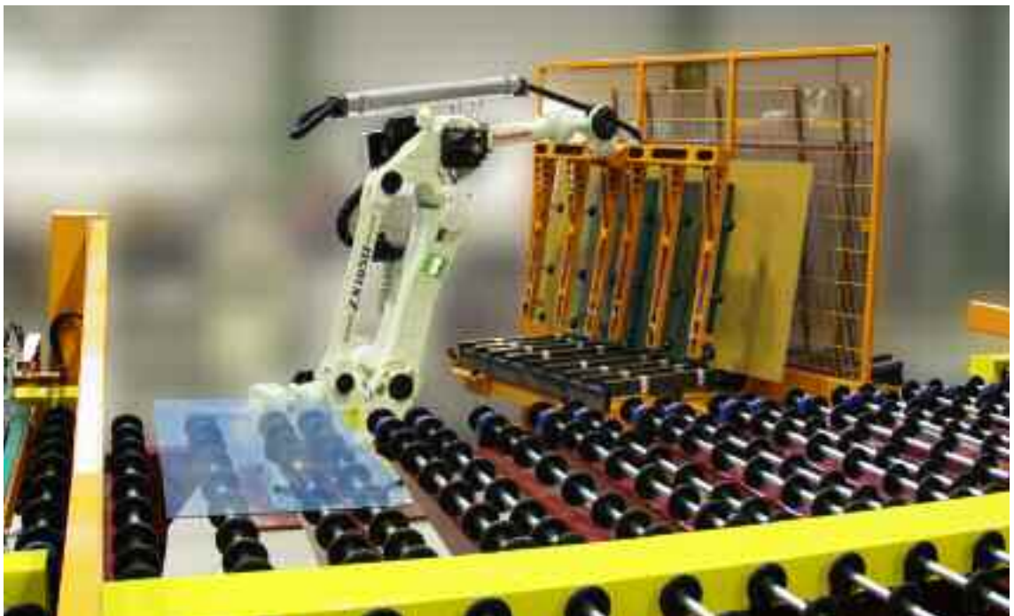
Einsatz von Robotertechnik zum automatisierten und schnellen Ab stapeln von zugeschnittenen Solarglasscheiben
