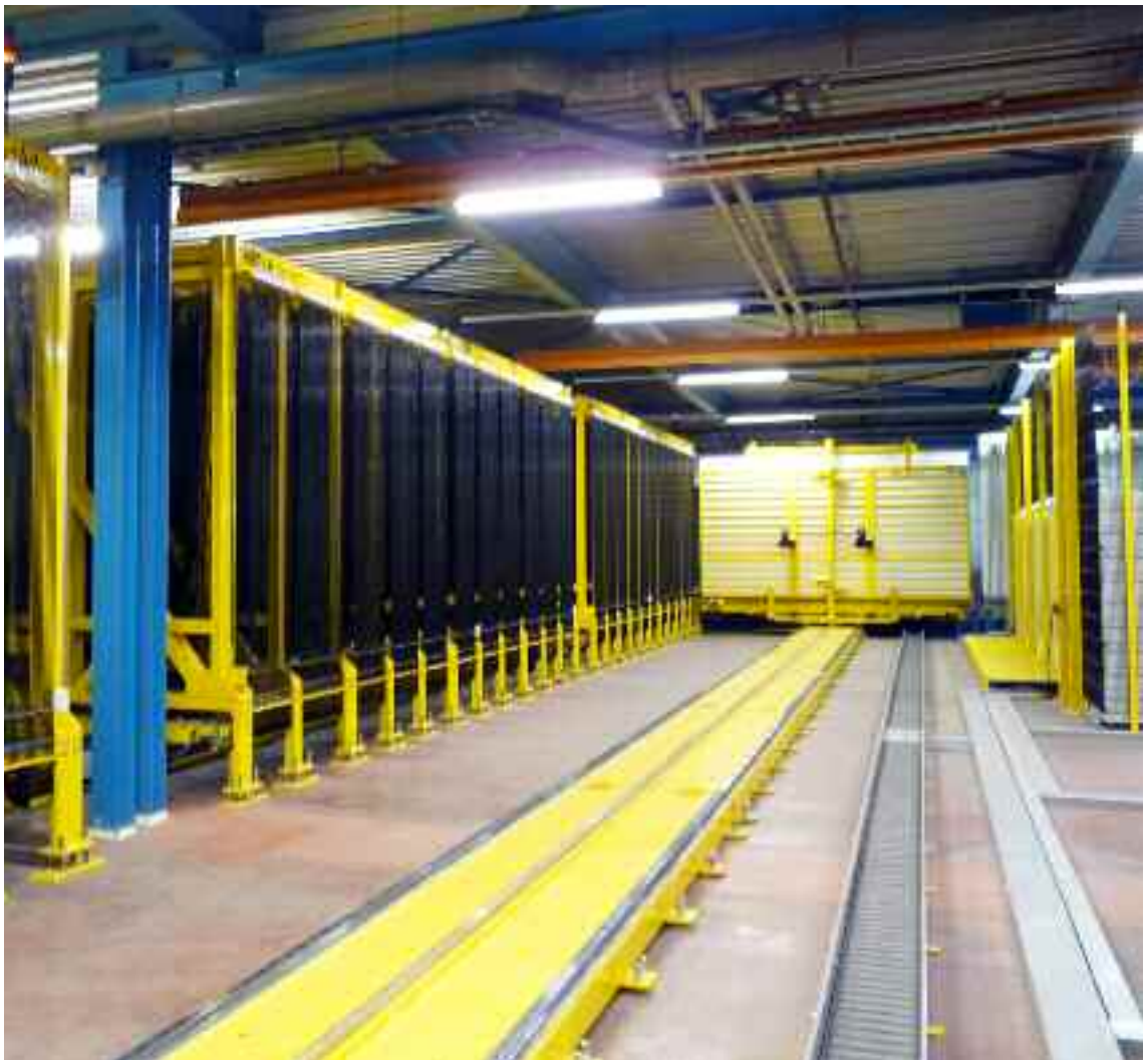
HEGLA-Sortjet zur Online-Produktion – direkt vom Glaszuschnitt zu den Isolierglas-/Bearbeitungslinien
