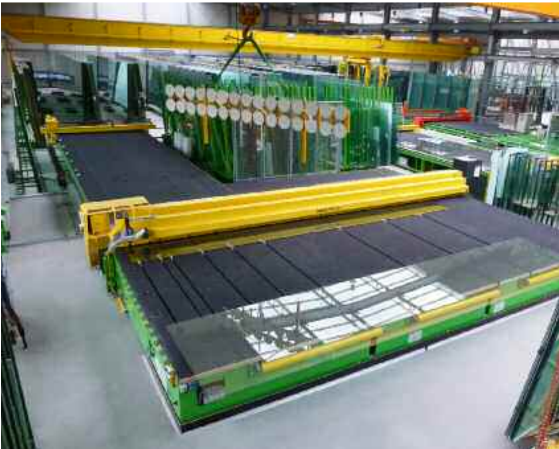
VSG-Zuschnitt im XXL-Format – die HEGLA ProLam ermöglicht präzise Traversenschnitte bis 9 m Länge
