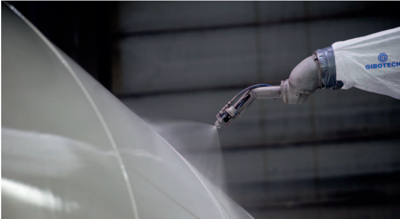
Beschichtungsroboter, Muehlhan Kanada
