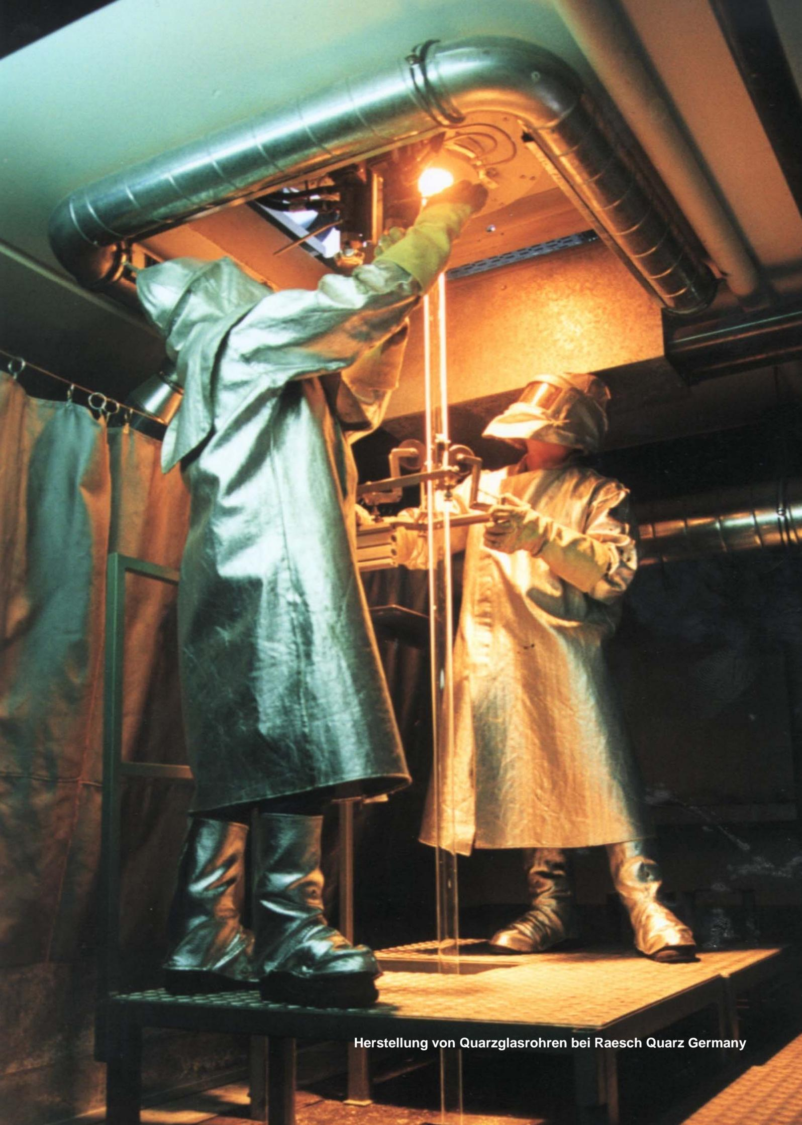
Herstellung von Quarzglasrohren bei Raesch Quarz Germany
