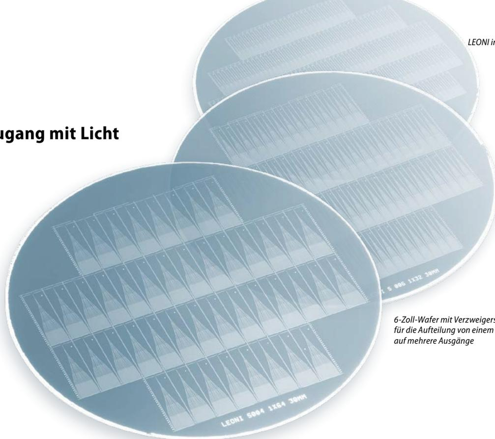
6-Zoll-Wafer mit Verzweigerstrukturen für die Aufteilung von einem Eingangssignal auf mehrere Ausgänge
