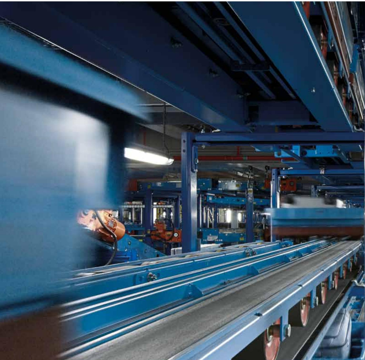
**Ground Handling** *6 Millionen zusätzliche Passagiere pro Jahr stellen auch neue Anforderungen an Organisation, Technik und Logistik: Die neue Gepäckförderanlage kann pro Stunde 5.000 Gepäckstücke zusätzlich sortieren. Mit einer Geschwindigkeit von bis zu 5 Metern pro Sekunde werden diese an ihren Zielort transportiert. Die über 7 Kilometer lange Erweiterung des bestehenden Systems bietet auf dem neuesten Stand der Technik ein Plus an Beförderungsmenge, Organisation und Zuverlässigkeit.*
