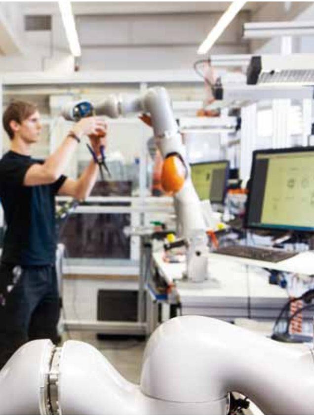
LINKS: In der Endmontage wird der LBR zusammengesetzt und verkabelt.
