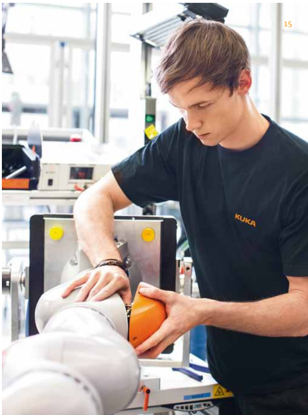
LINKS: In der Endmontage wird der LBR zusammengesetzt und verkabelt.
