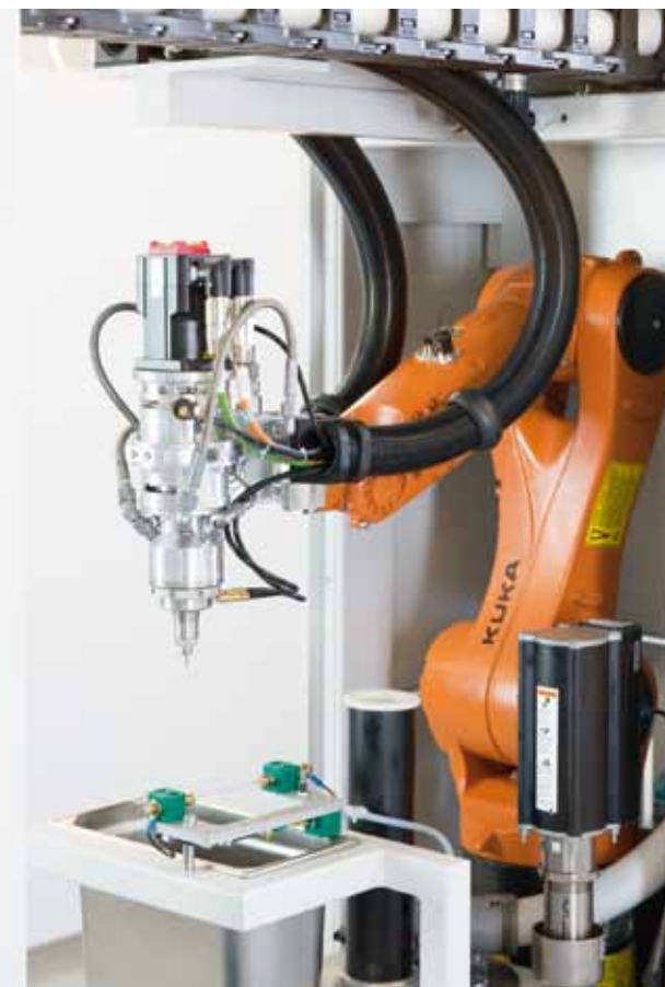
In einer kompakten Dosierzelle des baden-württembergischen Unternehmens RAMPF sorgt der KR AGILUS auf kleinstem Raum dafür, dass beim Schäumen, Vergießen, Kleben und Dichten richtig dosiert wird.
