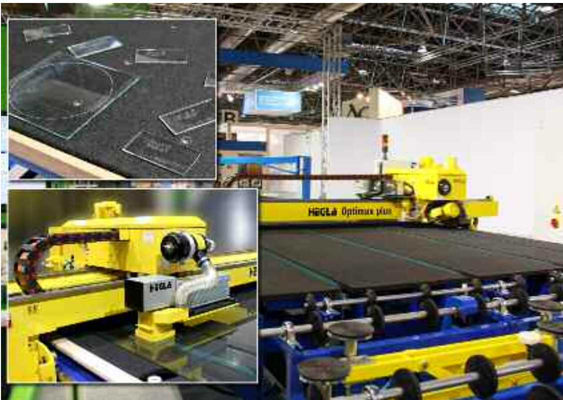
Laserkennzeichnung direkt auf der Glasschneidanlage zur Aufbringung von Beschriftungen, Logos und ESG-Stempeln
