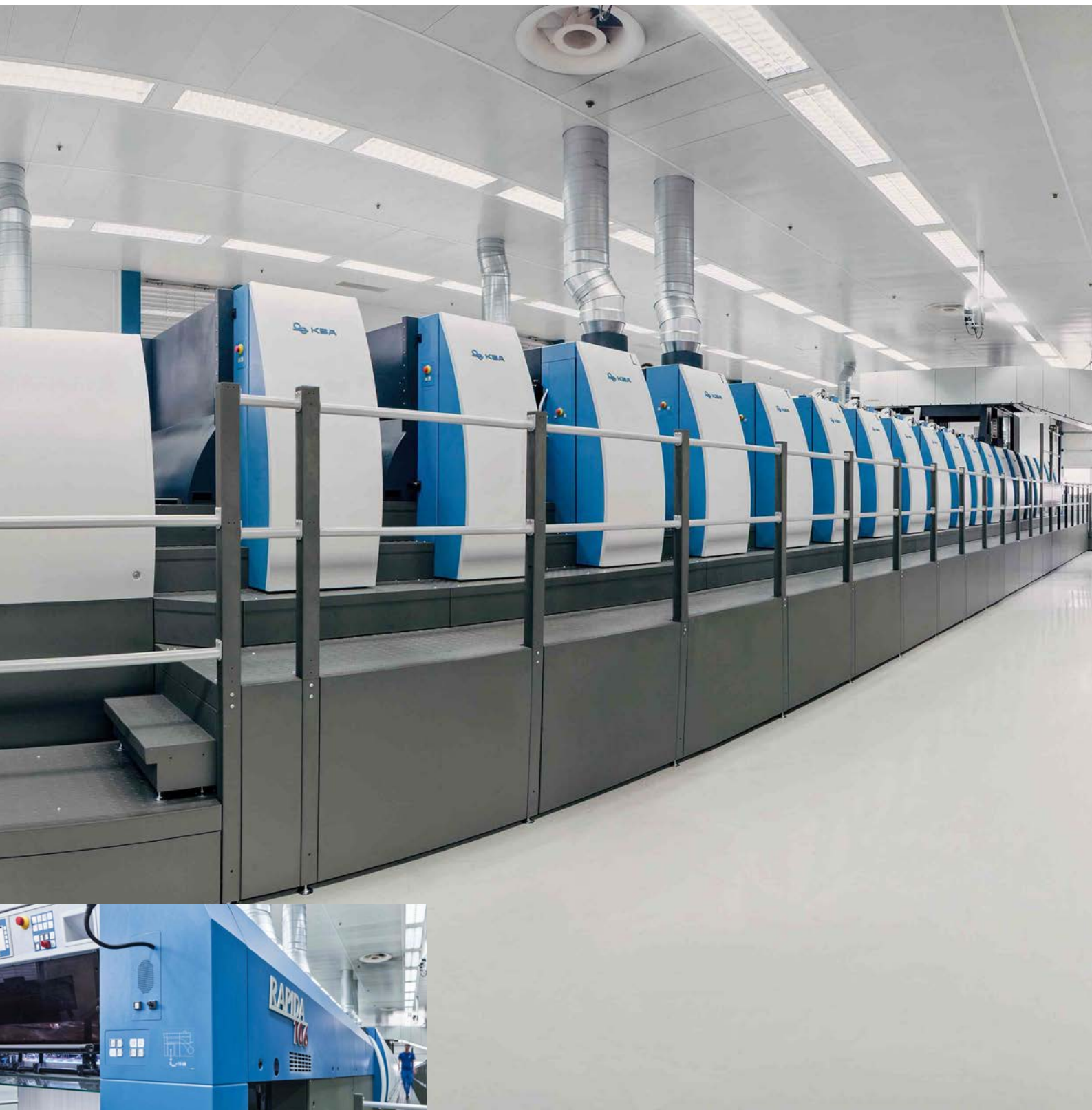
Die bei Amcor Tobacco Packaging in Rickenbach/Schweiz produzierende Rapida 106-Anlage mit 19 Druck- und Veredelungswerken setzt im Bogenoffset-Verpackungsdruck weltweit neue Maßstäbe
