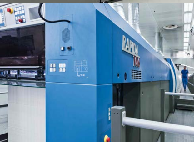
Die bei Amcor Tobacco Packaging in Rickenbach/Schweiz produzierende Rapida 106-Anlage mit 19 Druck- und Veredelungswerken setzt im Bogenoffset-Verpackungsdruck weltweit neue Maßstäbe
