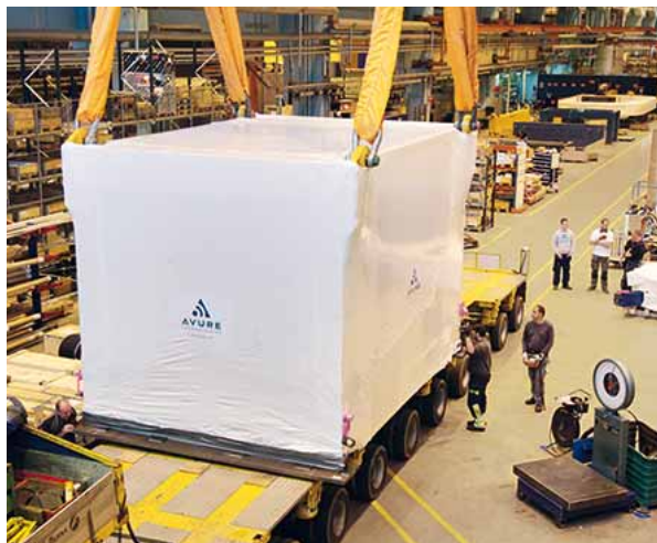
Angekommen: Das neue Graphitproduktionszentrum in Bonn erhielt nach 15 Monaten Bauzeit sein Herzstück, die größte kalt-isostatische Presse der Welt.
