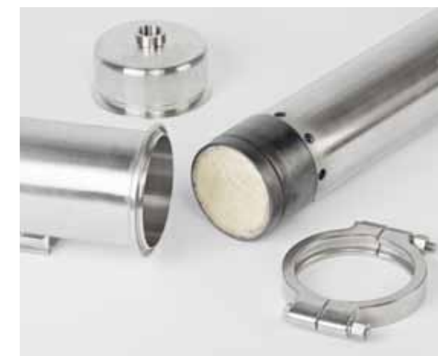
SEPURAN® Module bestehen aus mehreren tausend Hohlfasern, die aus Hochleistungskunststoffen hergestellt und in einem Edelstahlrohr gebündelt werden.
