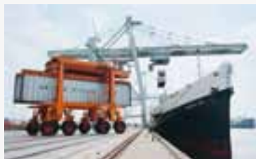
Vom Burchardkai aus trat der Portalhubwagen – weltweit Van-Carrier (VC) oder Straddle-Carrier genannt – ab Beginn der 1970er seinen weltweiten Siegeszug an.
