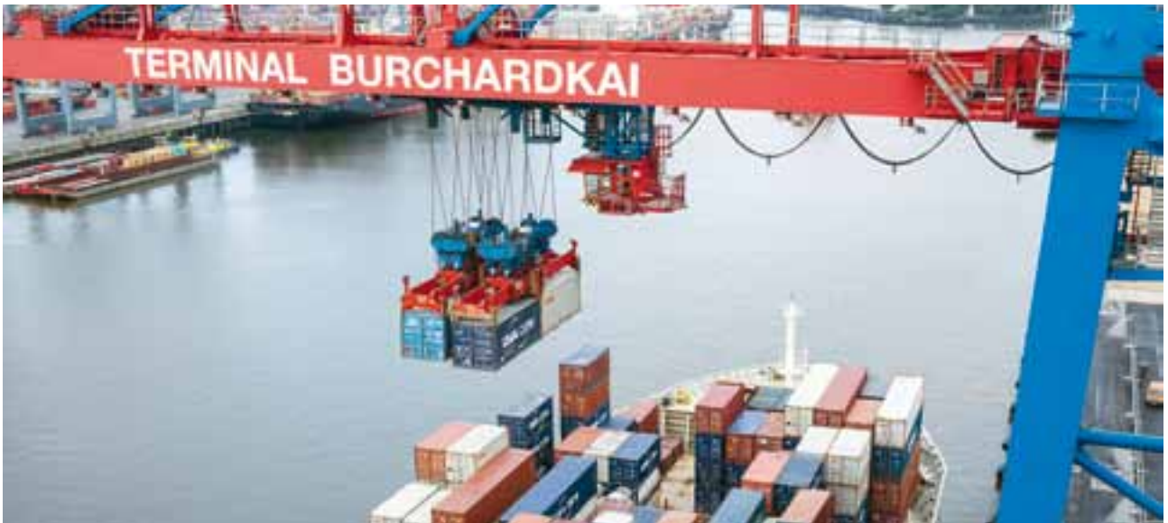
Innovativer Doppelpack: Tandembrücken löschen vier 20-Fuß-Container in einer einzigen Bewegung.
