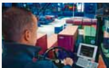
Seit 1984 ist die VC-Flotte mittels Datenfunk in das IT-System des CTB eingebunden. Jeder Containerstellplatz wird seit 1995 durch ein satellitengestütztes System geortet.
