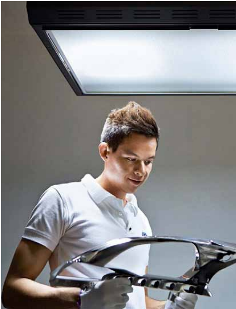
Optische Qualitätskontrolle eines Scheinwerferabdeckrahmens vor der Weiterverarbeitung.
