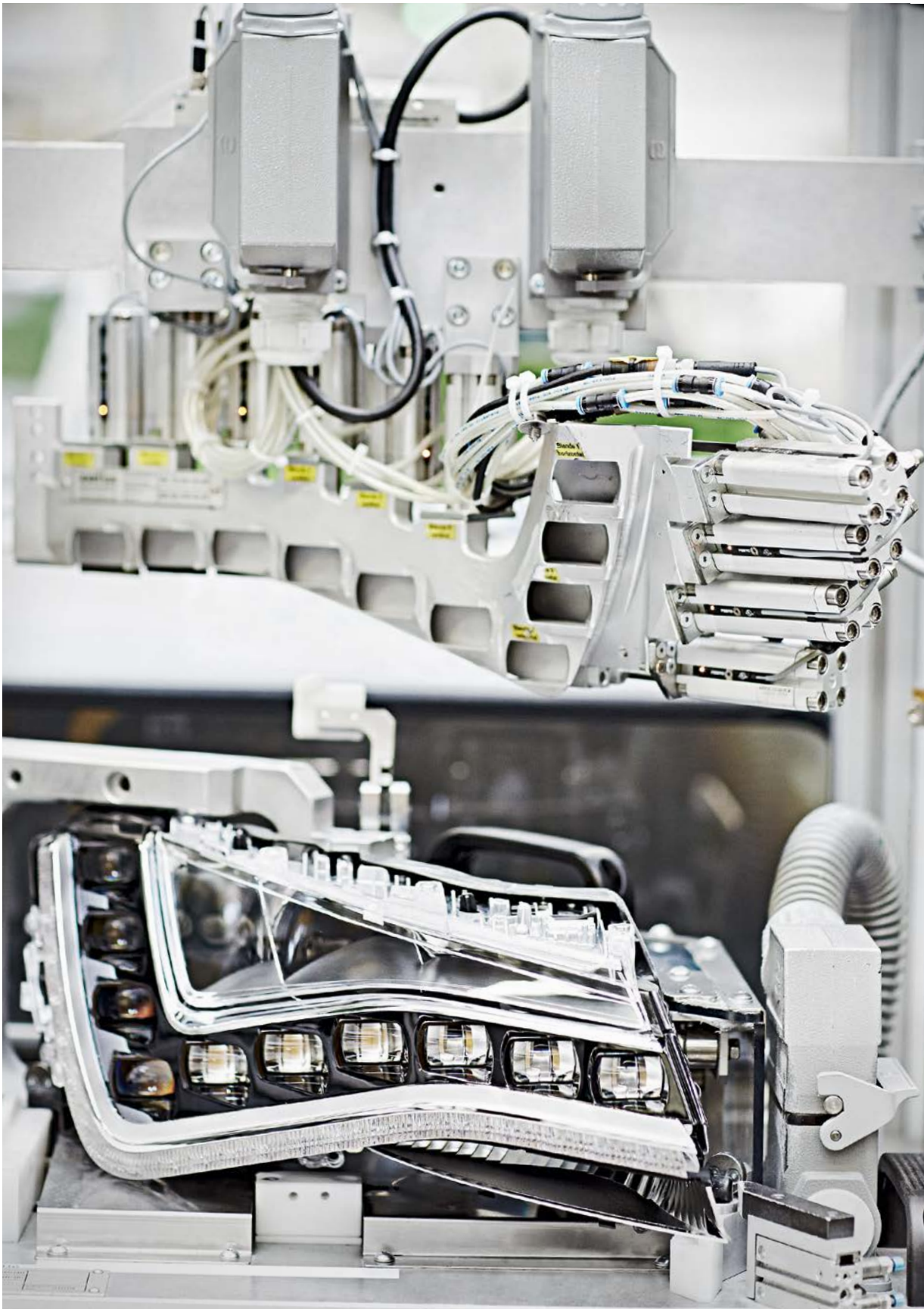
Zunehmend komplex: die Montage eines Voll-LED-Scheinwerfers in Lippstadt/Deutschland.
