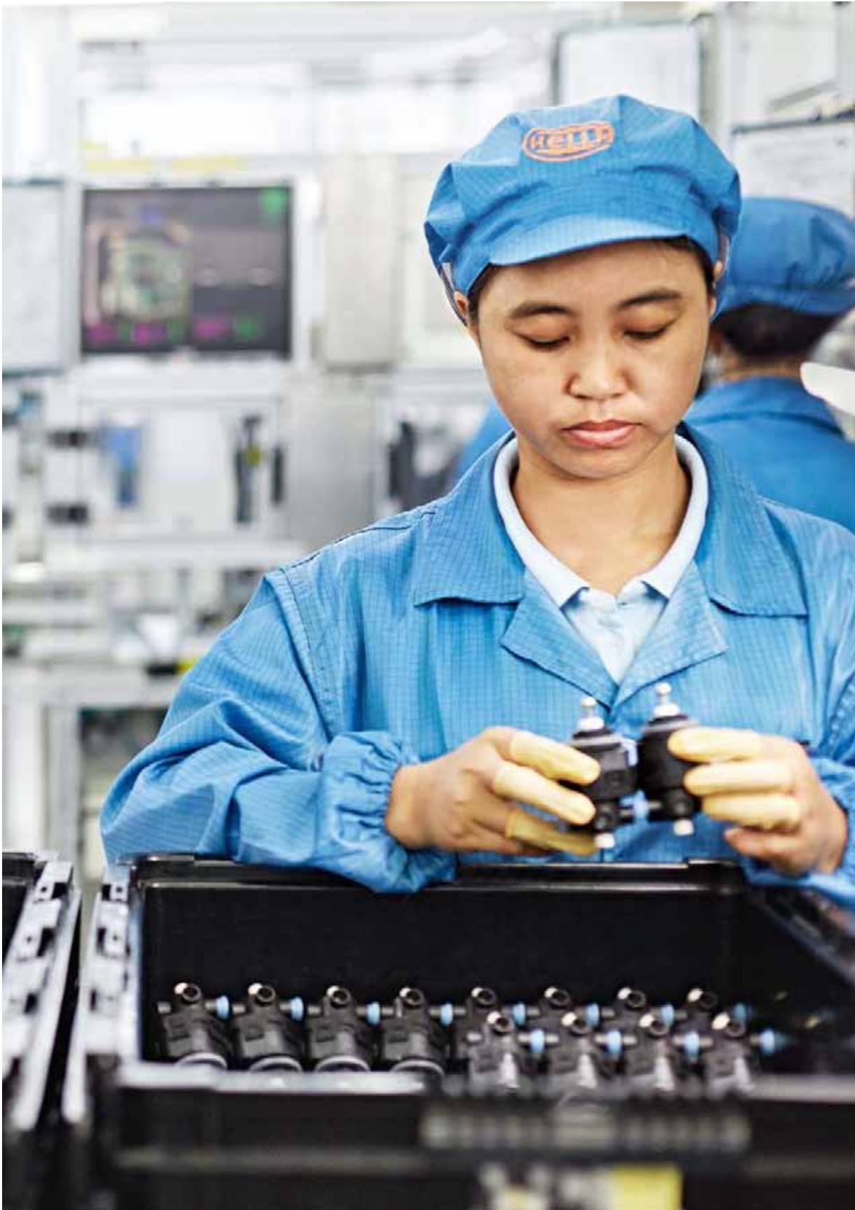
HELLA Shanghai Electronics agiert international, Qualität hat höchste Priorität. So auch bei der Kontrolle der Leuchtweitensteller.
