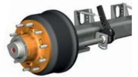
Starre Achse mit Trommelbremse
