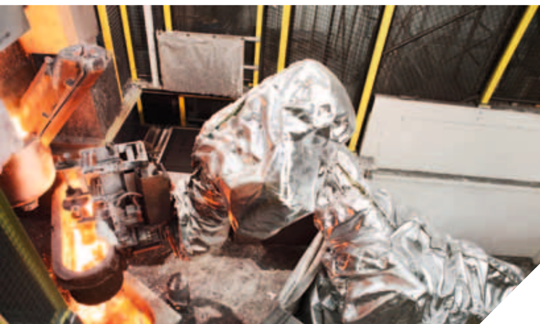
LINKS UND OBEN BEI DER GEORG FISCHER AG TROTZT DER KUKA KR 1000 TITAN EXTREMER HITZE UND SCHMUTZ.
