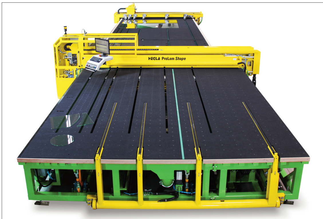
Passgenaues und automatisiertes Modellschneiden von Verbundsicherheitsglas mit der ProLam Shape von HEGLA
