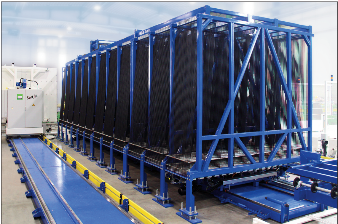
HEGLA-SortJet zur automatischen Sortierung von Glasscheiben zwischen Glaszuschnitt und den Isolierglas-/Bearbeitungslinien
