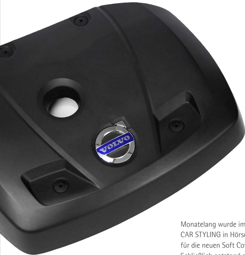
**Die POLYTEC GROUP erweiterte 2013 ihr Produktportfolio um einen weiteren innovativen Bauteil für die Automobilindustrie. Das Engine Soft Cover ist eine Motorblockabdeckung, die in einem einzigen Produktionsschritt aus PUR-Weichschaum gefertigt wird. Sie wird künftig in allen Benzinfahrzeugen von Volvo die konventionellen Spritzgussabdeckungen ersetzen und nicht nur für Kosten- und Gewichtsreduktionen, sondern auch für mehr Komfort und Sicherheit sorgen.**
