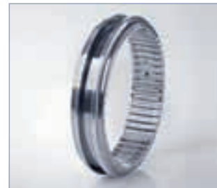
Die Verzahnung einer Schaltmuffe überträgt beim Gangwechsel das Drehmoment
