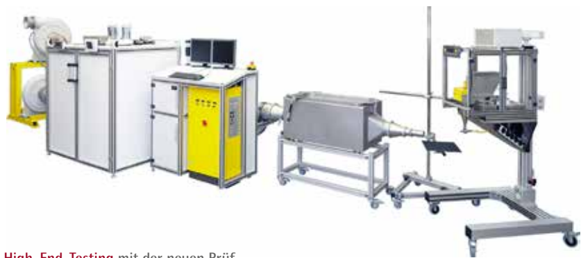
High-End-Testing mit der neuen Prüf- anlage für Luftfiltersysteme in Lohne.
