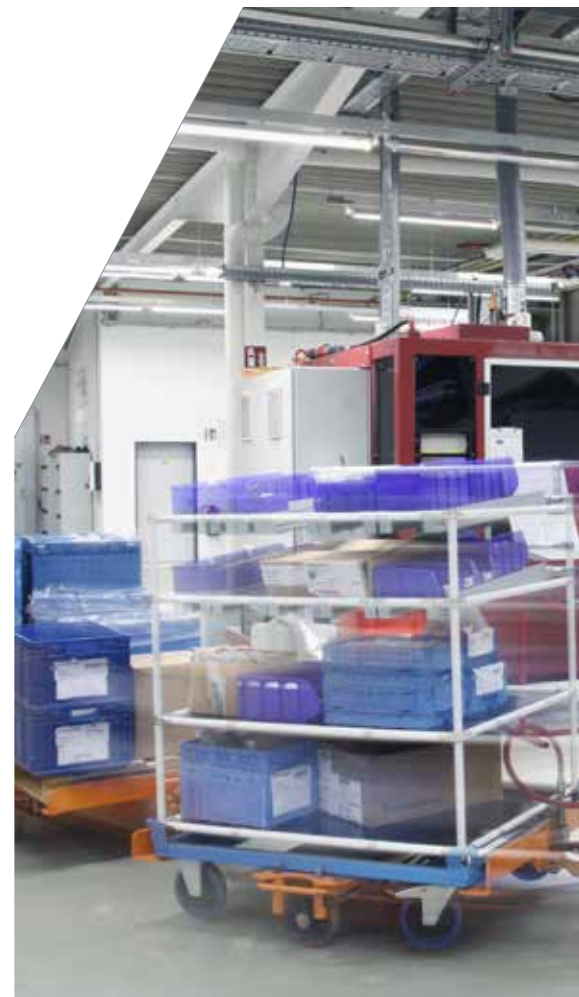
Im Zwei-Stunden-Takt versorgt der Routenzug auf einer klar definierten Strecke die Fertigungslinien mit Zukauf- und Halbfertigteilen und reduziert damit die logistischen Wege im Vergleich zur Versorgung per Stapler.
