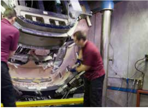
Produktion des Stoßfängers im PUR-RRIM-Verfahren
