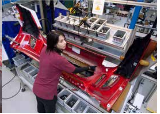
1.000 verschiedene Stoßfänger-Varianten erfordern ein komplexes technisches Kontrollsystem, das die Mitarbeiter am POLYTEC-Standort Bromyard bei der Montage unterstützt.
