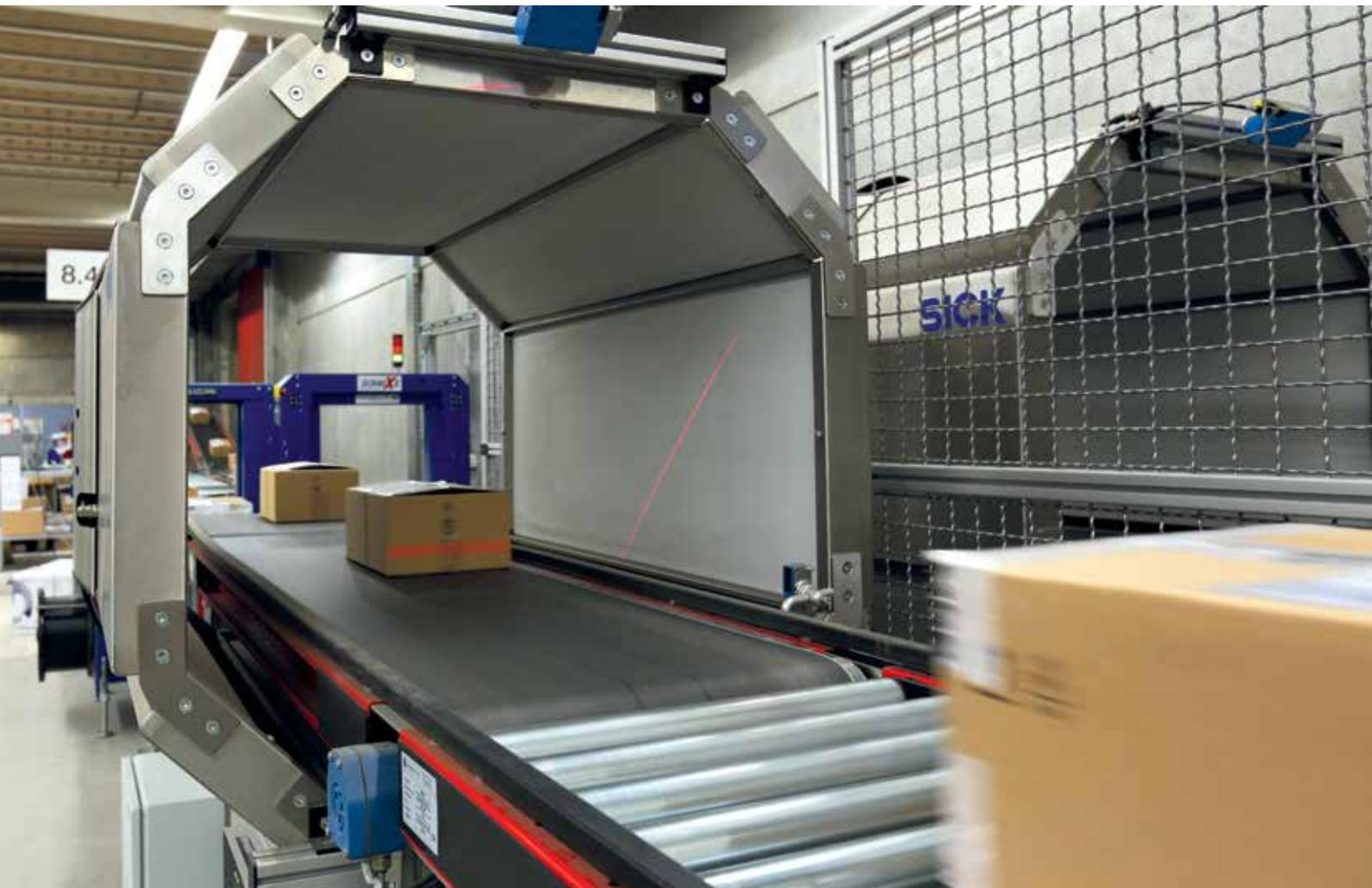
sowohl die Liegeware (fertig gepackte Kartons) als auch die hängend ausgelieferte Ware spezielle RFID-Tunnel. Die Auslesung der Daten erfolgt problemlos.
