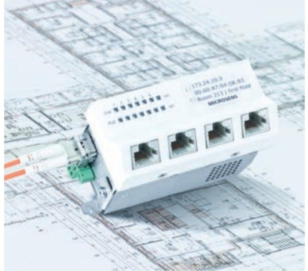
Der Installations-Switch von MICROSENS bringt als Gigabit-Switch mit Glasfaseranbindung Höchstleistung in Form vielfältiger Applikationen direkt zum Arbeitsplatz.
