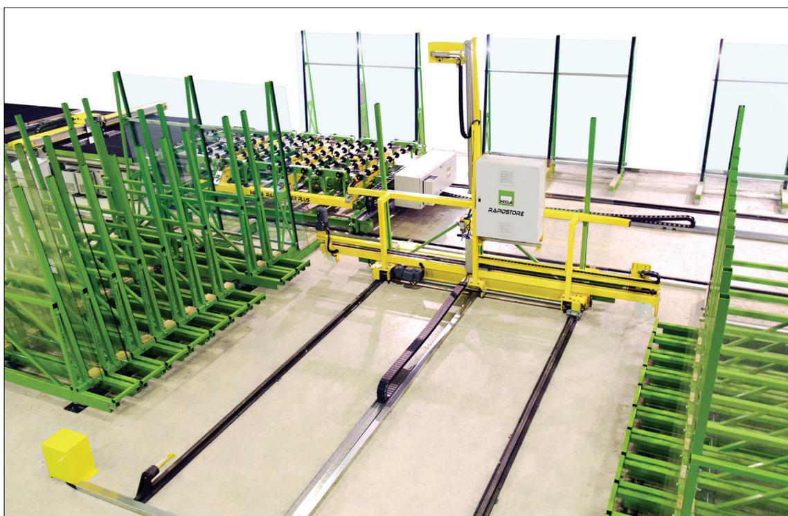
HEGLA-Rapidstore – Automatisches Shuttle-Lagersystem zur Glasbereitstellung
