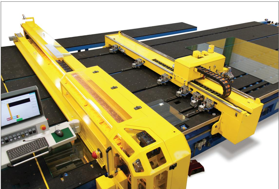
Mit der AvdaLam Shape von HEGLA lassen sich freie Formen und Modelle aus Verbundsicherheitsglas automatisch und präzise ritzen.
