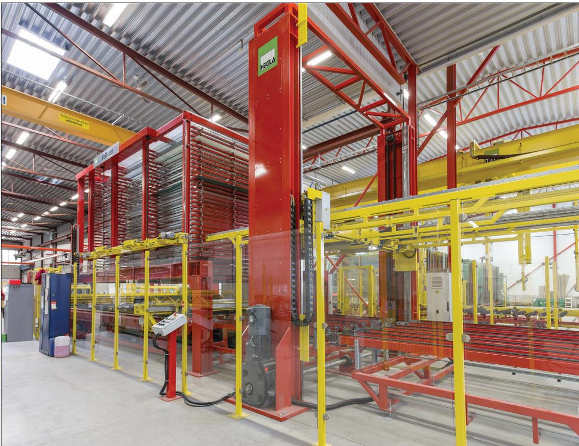
Material- und Handlingskosten reduzieren mit dem dynamischen Restblattspeicher ReMaster von HEGLA
