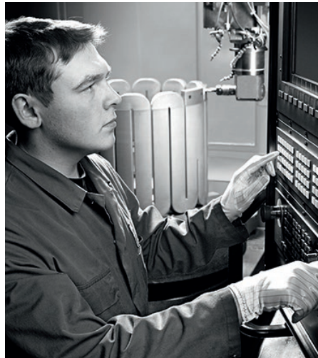
Bearbeitung eines Mäanderheizers aus Feinkorngraphit für die Halbleiterindustrie
