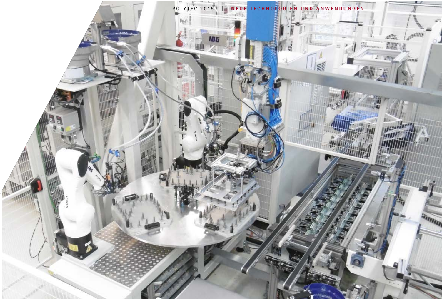
Auf einem Rundschalttisch wird der Spritzgussvorgang vollautomatisch vorbereitet. Er bildet das Kernstück einer hoch komplexen Produktionslinie, die eigens für das Projekt entwickelt wurde.
