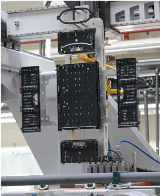
Nach dem Spritzgießen entnimmt ein Roboter die unterschiedlichen Teile der Mehrwegbox, bevor diese vollautomatisch zusammengebaut, mit einem individuellen Code etikettiert und bedruckt wird.
