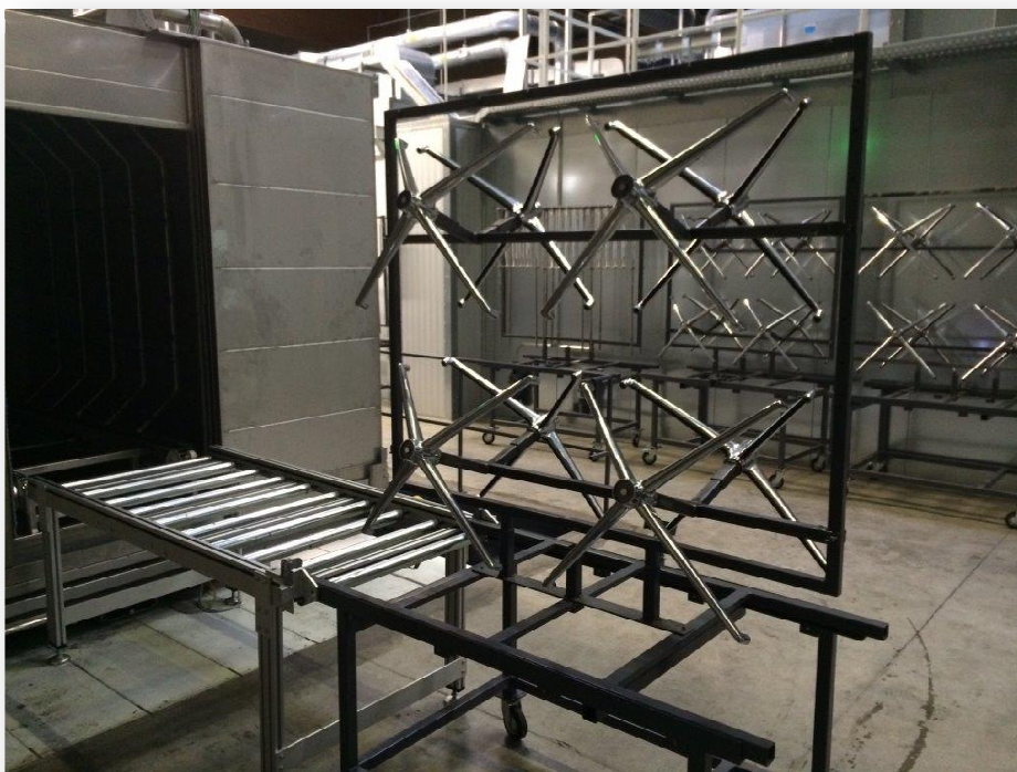
Möbelteile vor Beginn des Beschichtungsprozesses an der Vorbehandlungsanlage
