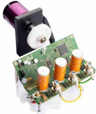
Demonstrator für eine 48V-Motorsteuerung in Kooperation mit Infineon
