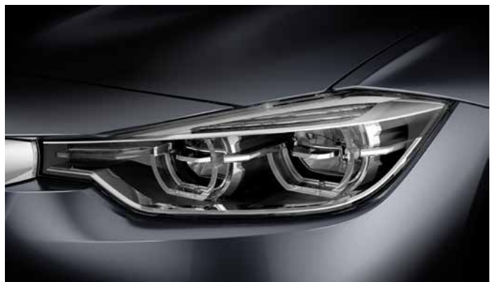
Die höchste Ausstattungsvariante des BMW 3er verfügt über lichtbasierte Fahrerassistenz-Systeme mit adaptiven Kurvenlicht, variabler Stadt- und Autobahn-Lichtverteilung sowie blendfreiem Fernlicht. (Quelle: HELLA)
