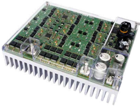
Dickkupfer 48/12V DC/DC Converter in Kooperation mit Infineon
