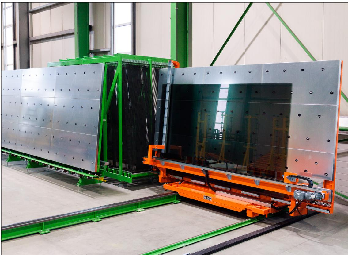
Vertikale Restblatt-Zwischenspeicherung von HEGLA zur Reduzierung der Glasverschnittkosten.
