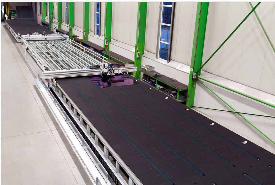
Floatglaszuschnitt für Überformate: Die Galactic-Schneidlinie mit Linearantrieben für Glaslängen bis 20m.
