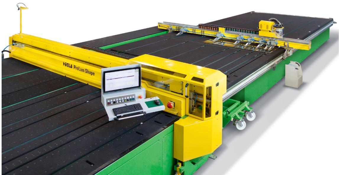
ProLam Shape – Modellschneidanlage für Verbundsicherheitsglas mit neuer Schrägschnittvorrichtung
