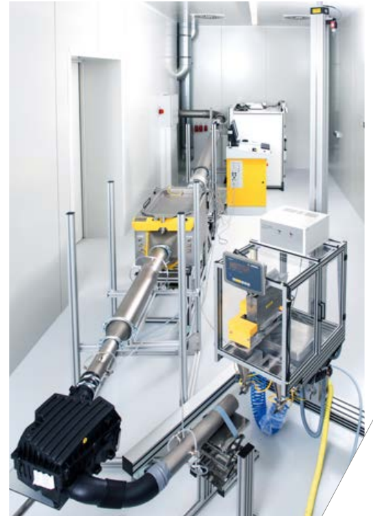
Testing eines Luftfiltersystems an einem Prüfstand.
