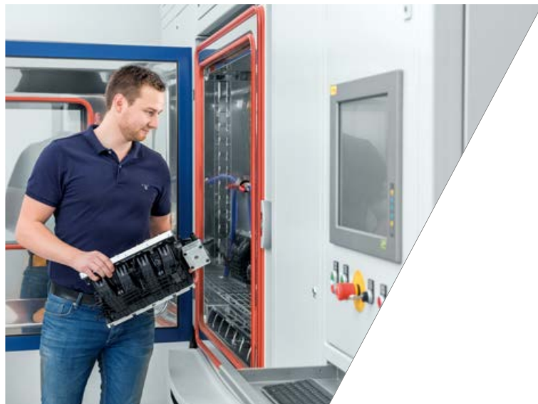
In der Pulsationsprüfanlage werden Bauteile auf strukturelle Schwachstellen untersucht.
