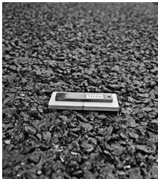
BAB 2 Rehren, Offenporiger Asphalt mit Temperaturdokumentation
