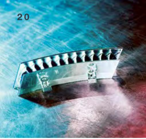
Mit 3D-Druck lassen sich die Leitschaufel-segmente einer MAN-Gasturbine aus einem Stück herstellen. Vorher bestanden sie aus zwölf einzelnen Leitschaufel-Paaren.
