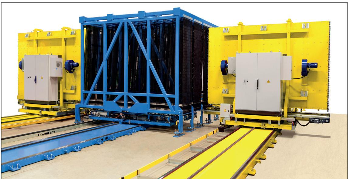
Der Sortjet von HEGLA – direkt vom Zuschnitt auf die nachfolgenden Bearbeitungsstationen, ohne Taktverlust und in richtiger Reihenfolge
