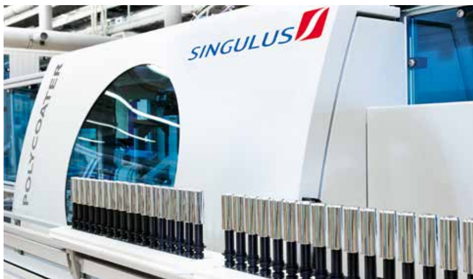
POLYCOATER Kathodenzerstäubungsanlage für die Vergütung von Konsumgüterartikeln wie z. B. aus dem Bereich Kosmetik
