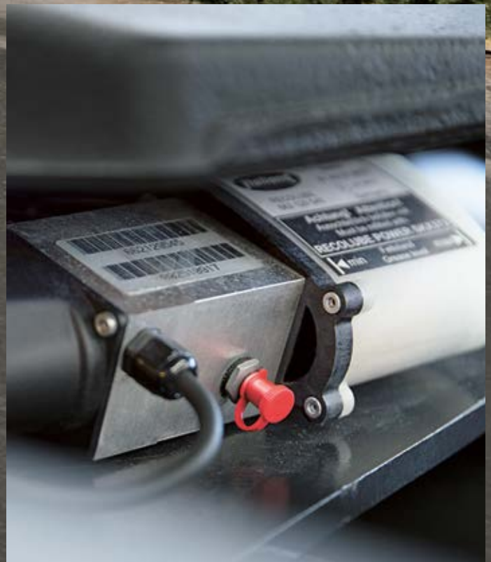
Mit der automatischen Schmierpumpe RECOLUBE müssen Sattelkupplungen nicht mehr von Hand geschmiert werden.
