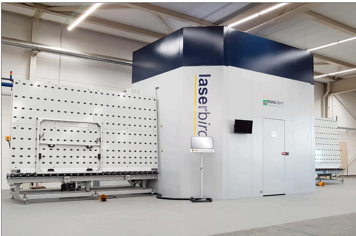
Der Laserbird von HEGLA boraident zur oberflächenschonenden Bearbeitung von LowE-Schichten auf Flachgläsern mittels Lasertechnologie
