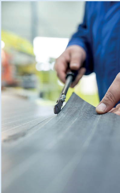
Karl Eugen Fischer produziert Maschinen, mit denen Stahlcord, das tragende Gerüst eines Autoreifens, hergestellt wird. Damit das Material sauber geschnitten werden kann, ist das Messer beheizt.
