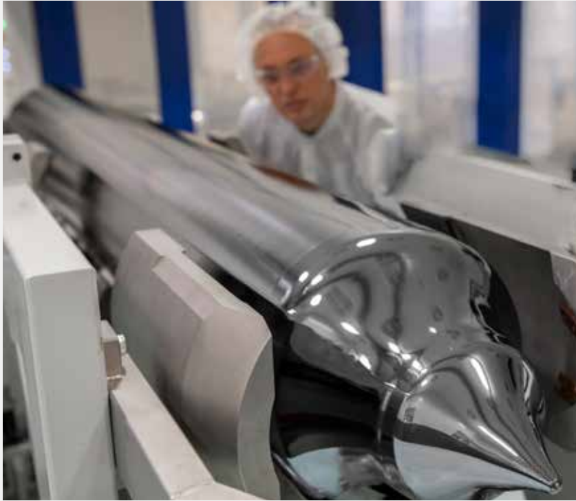
Ein Mitarbeiter kontrolliert den aus der Anlage ausgebauten Kristall auf Versetzungen.
