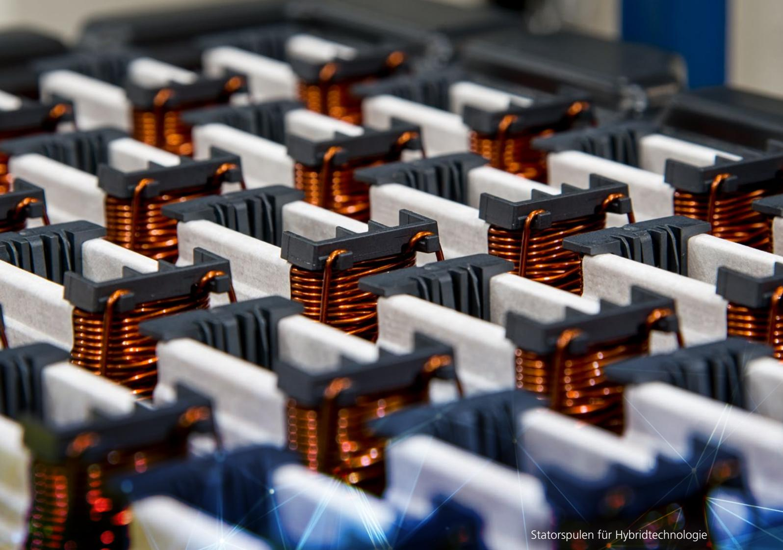
Statorspulen für Hybridtechnologie
