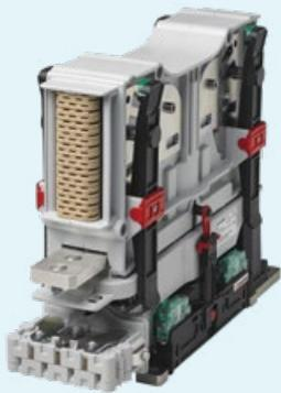
Mit der CP-Schützreihe hat Schaltbau ein äußerst innovatives Schaltgerätekonzept im Sortiment. Die patentierte und ausschließlich permanent-magnetische Lichtbogenbehandlung gewährleistet volle Bidirektionalität und ermöglicht eine noch kompaktere Bauweise. Das spart wertvollen Platz- und reduziert Gewicht. Erstmals können die universellen Geräte als Schließer oder Öffner, als Trenner oder Umschalter konfiguriert werden. So lassen sich unterschiedliche Anforderungen flexibel realisieren.
