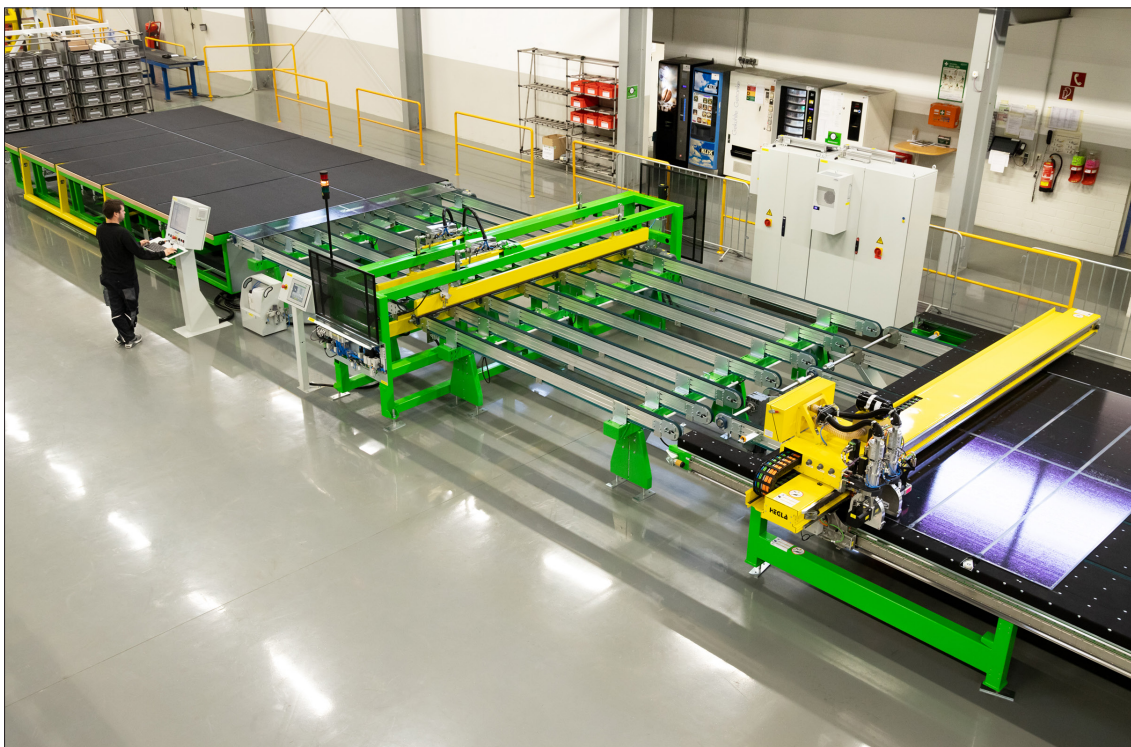
HEGLA Rapidline für den Floatglaszuschnitt inklusive automatischer Brechstation sowie des weiterentwickelten EasyPro- und TPF-Schleifens.
