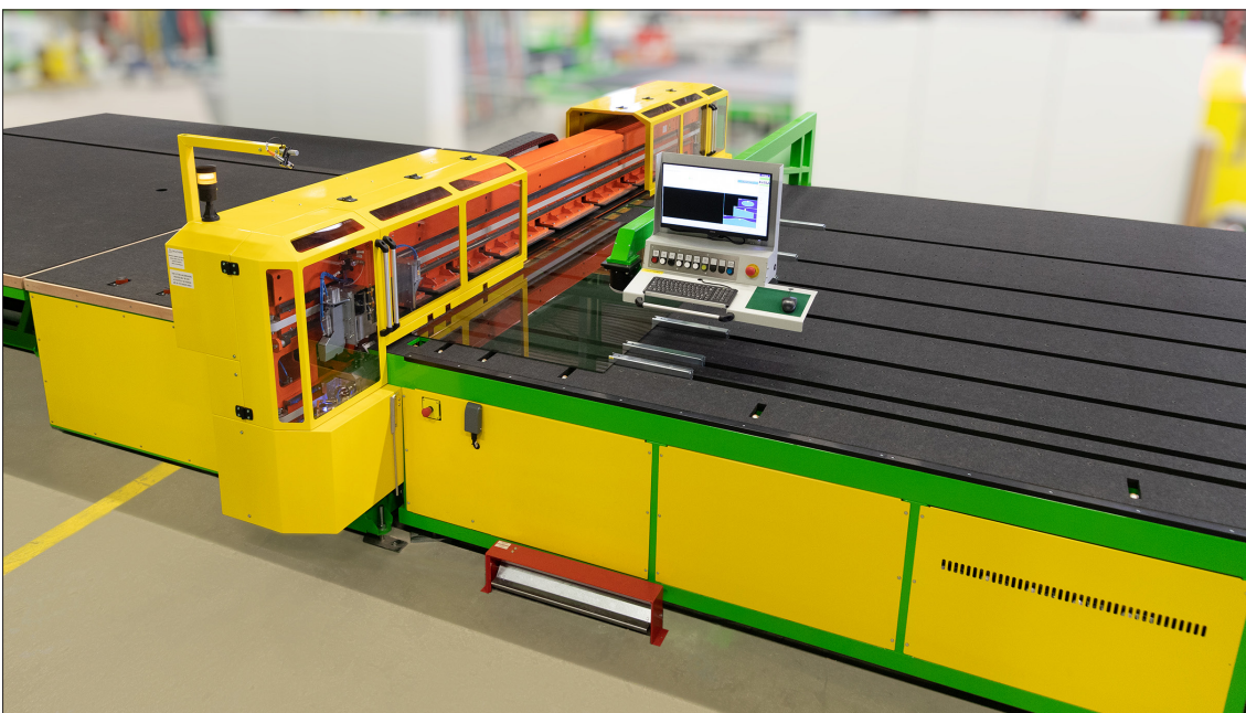
HEGLA RapidLam einschließlich patentiertem Modellritzen zum Schneiden freier Formen und Modelle aus Verbundsicherheitsglas mit höchster Präzision.
