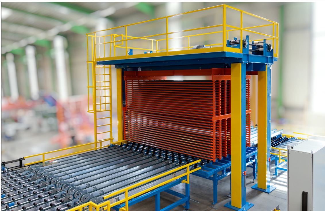
HEGLA Akkumulator zur Zwischenspeicherung von Gläsern während des Gestellwechsels einer Beschichtungslinie. Durch den automatischen Ein- und Austransport werden die Glasscheiben gepuffert und ein kontinuierlicher Produktionsprozess erzeugt.
