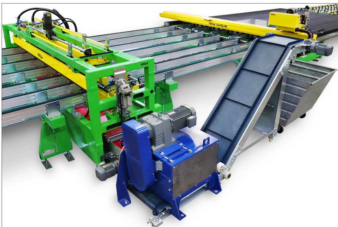
Automatische Scherbenbrecher ergänzen zukünftig das Produktportfolio der HEGLA-Gruppe. In der Produktion entstehende und nicht weiterverwendbare Glas-Reststücke werden zerkleinert und automatisch entsorgt.
