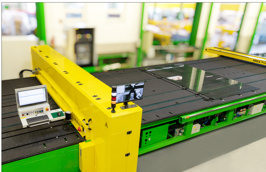
HEGLA ProLam LSR mit patentierter Laserdiodenheizung zur Verkürzung der Bearbeitungszeiten und Steigerung der Produktivität im Zuschnitt von Verbund sicherheitsgläsern.
