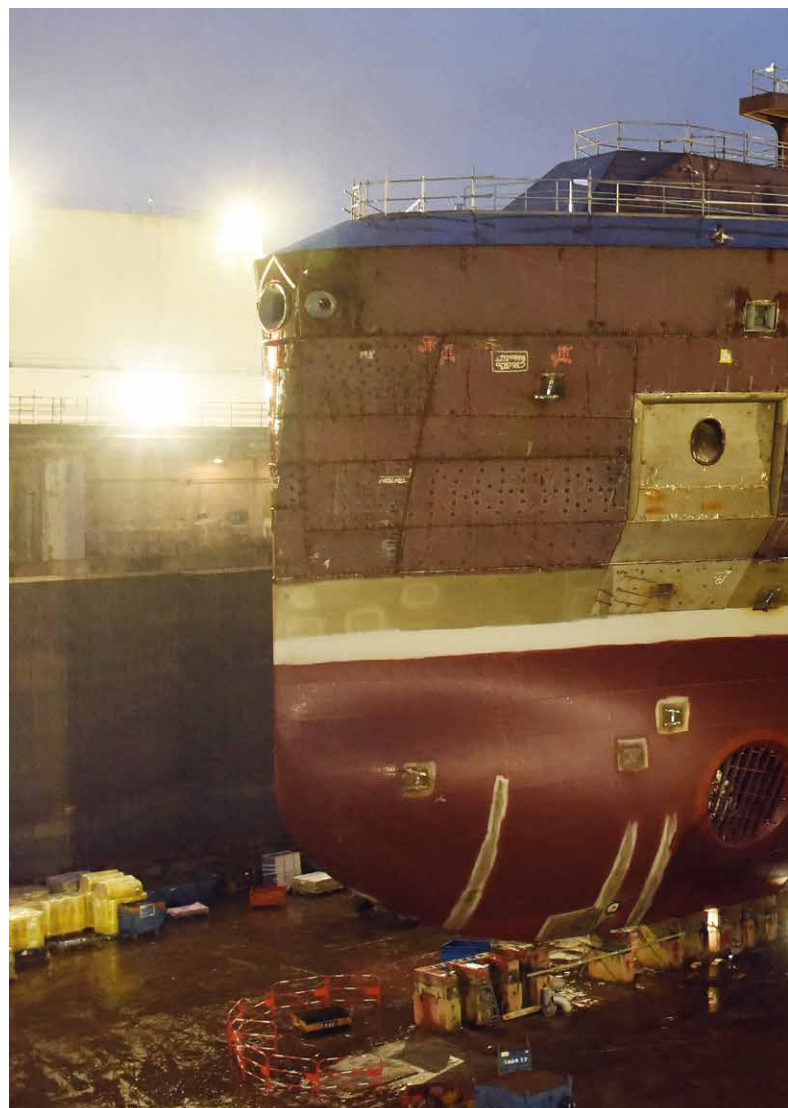
Oberflächenschutzarbeiten an einem Schiffsrumf
