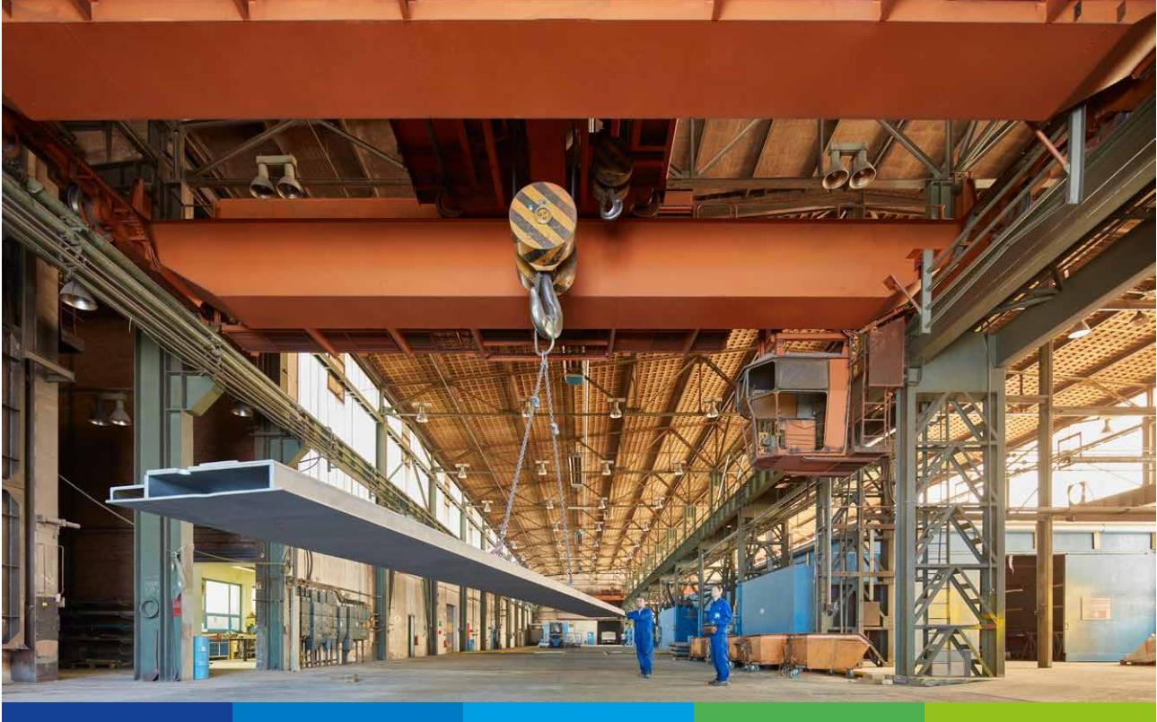
Transport von beschichtetem Stahlträger
