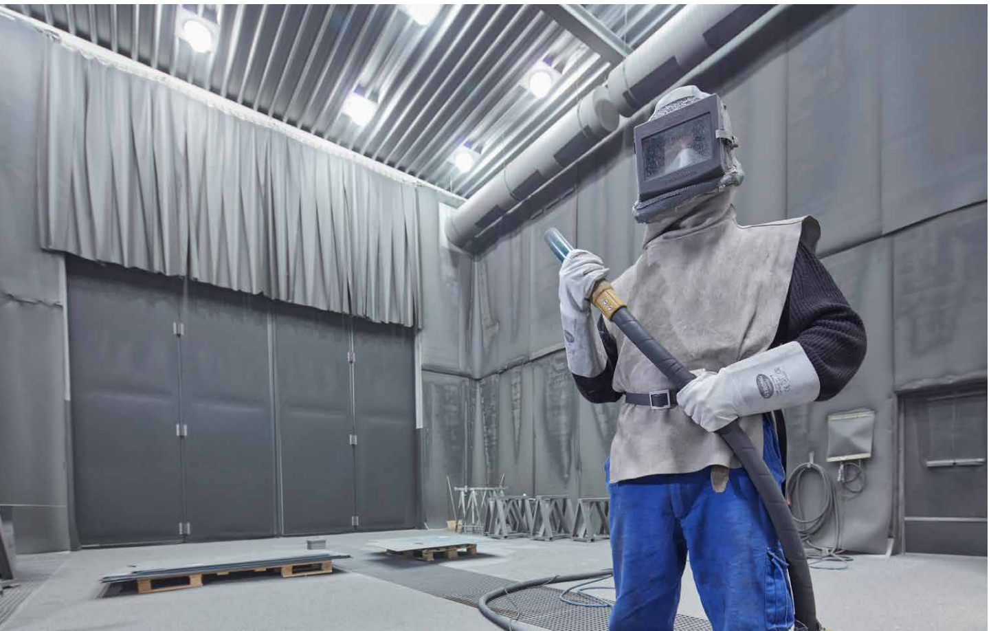
Muehlhan Mitarbeiter in Schutzausrüstung in einer Strahlhalle
